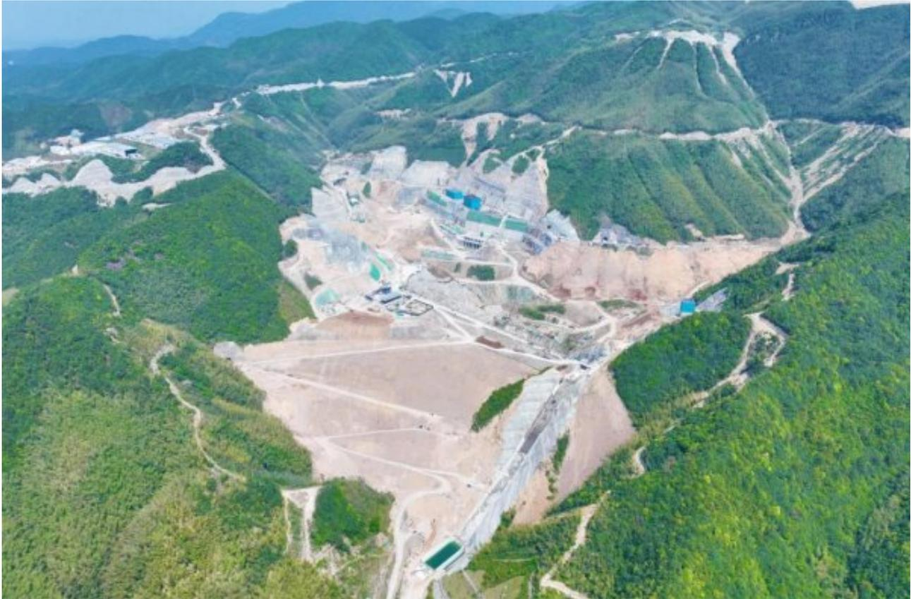
浙江衢江抽水蓄能电站位于浙江省衢州市衢江区黄坛口乡境内，公司承建该电站4台300兆瓦可逆式水轮发电机组及附属设备安装调试，以及主副厂房、母线洞、500千伏地面开关站等部位土建装修工程。
