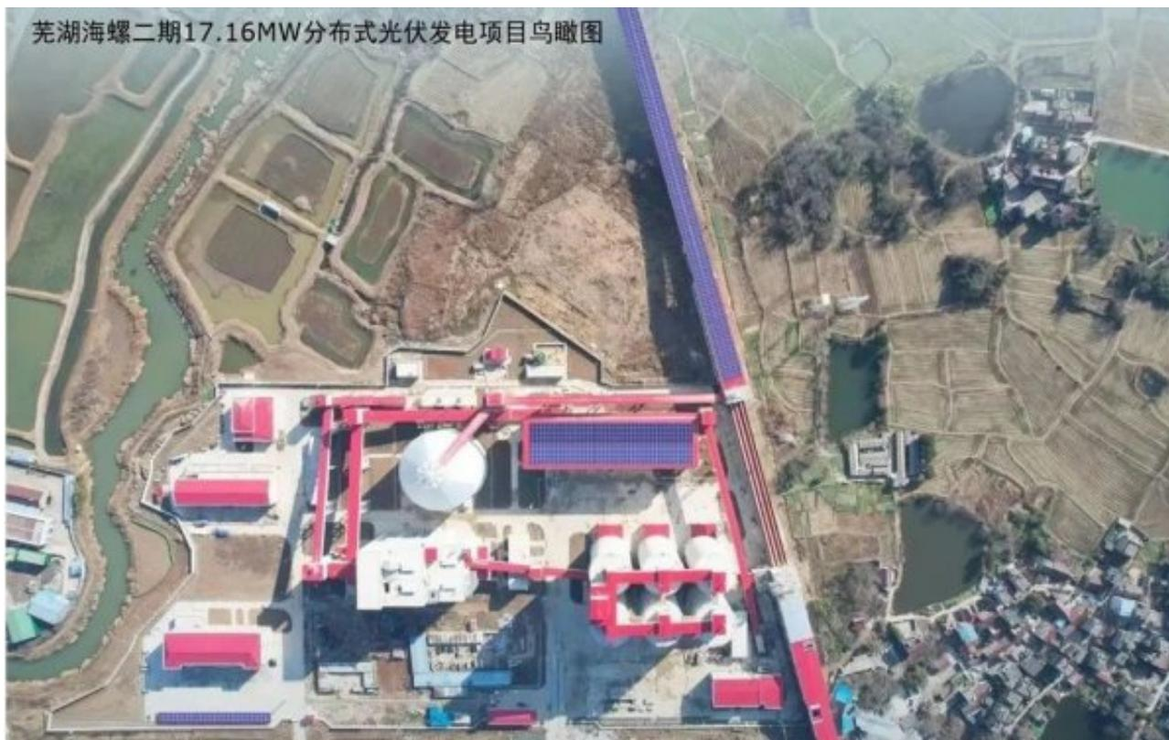
该项目利用芜湖海螺水泥厂现有9.8km水泥传输带廊道屋面及停车场作为光伏发电场地，共计3处高压、3处低压并网节点，采用615Wp单晶硅组件及130Wp光伏瓦组件，总装机容量为17.16MWP，发电模式为自发自用，余电上网。
