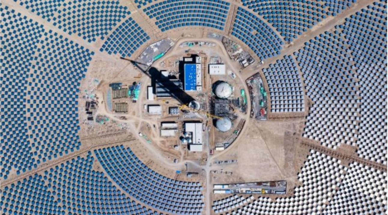
“目前，储热型光热项目的土建部分已全部施工完毕，设备安装及调试工作正有序推进，总体进度已达85%，力争在今年8月左右实现并网发电。”罗正国系统地介绍了发电的原理。他表示，尽管目前定日镜尚未投入使用，但可以预见，未来它们将在阳光的“指挥”下，整齐划一地调整角度，精准地将阳光反射至吸热塔。届时，这里将源源不断地把太阳能转化为清洁电能，为绿色能源的发展贡献力量。
