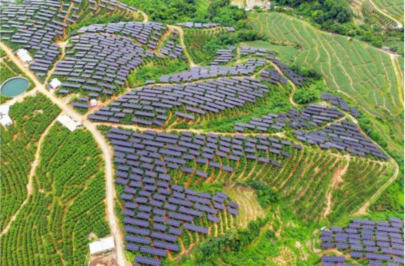
项目位于云南省玉溪市新平彝族傣族自治县漠沙镇境内，光伏场区总用地面积3200亩，规划装机容量135兆瓦，储能容量15兆瓦/30兆瓦时。施工内容包括光伏区、35千伏集电线路、110千伏升压站及监控中心、储能系统、送出工程、对侧变电站改造等工程，规划以110千伏线路电压等级接入电网。
