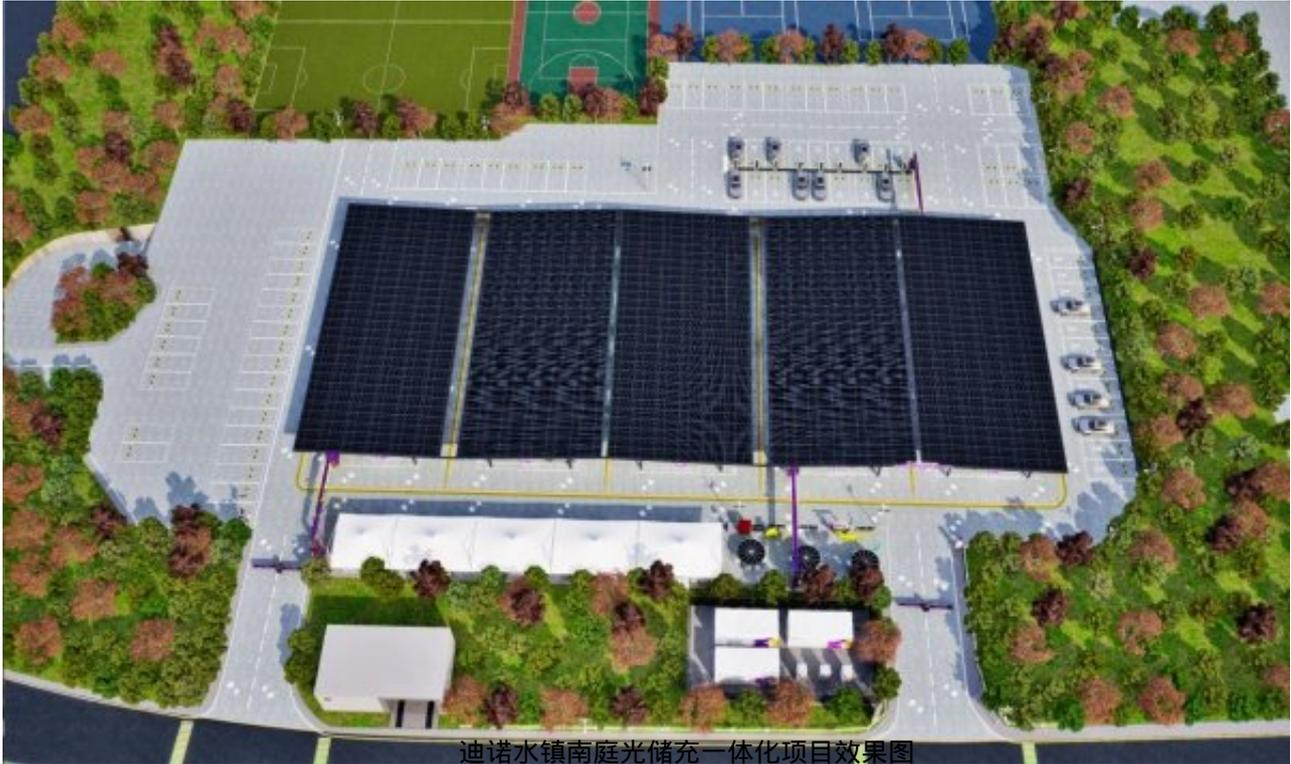
项目建设热潮同样在迪诺水镇南庭光储充一体化项目现场上演。这个总投资近千万的重点项目，充分利用迪诺水镇南庭闲置地块结合新能源业务变身多元化微电网场景。自5月立项以来，一路高效推进，项目通过“光伏+储能+充电+休闲”多能互补模式，构建起分级充电服务体系，满足各场景充电需求。场站设有115个充电车位，除常规快慢充电桩外，首次使用兆瓦级液冷超充设备，实现“一秒一公里”充电速度。场站同步配置6套V2G双向充放电系统，积极响应常州市首批车网互动规模化应用试点城市建设。项目投运后年光伏车棚全年发电量约为51.7万度，年减少碳排放约406吨，节约充电成本约27万元。场站积极融入恐龙特色，引入多元商业业态，车主在享受高效充电服务的同时还能在专属休闲区放松身心。完善的配套设施与延伸服务，显著提升了充电场站的附加值，为绿色出行增添人文温度。
