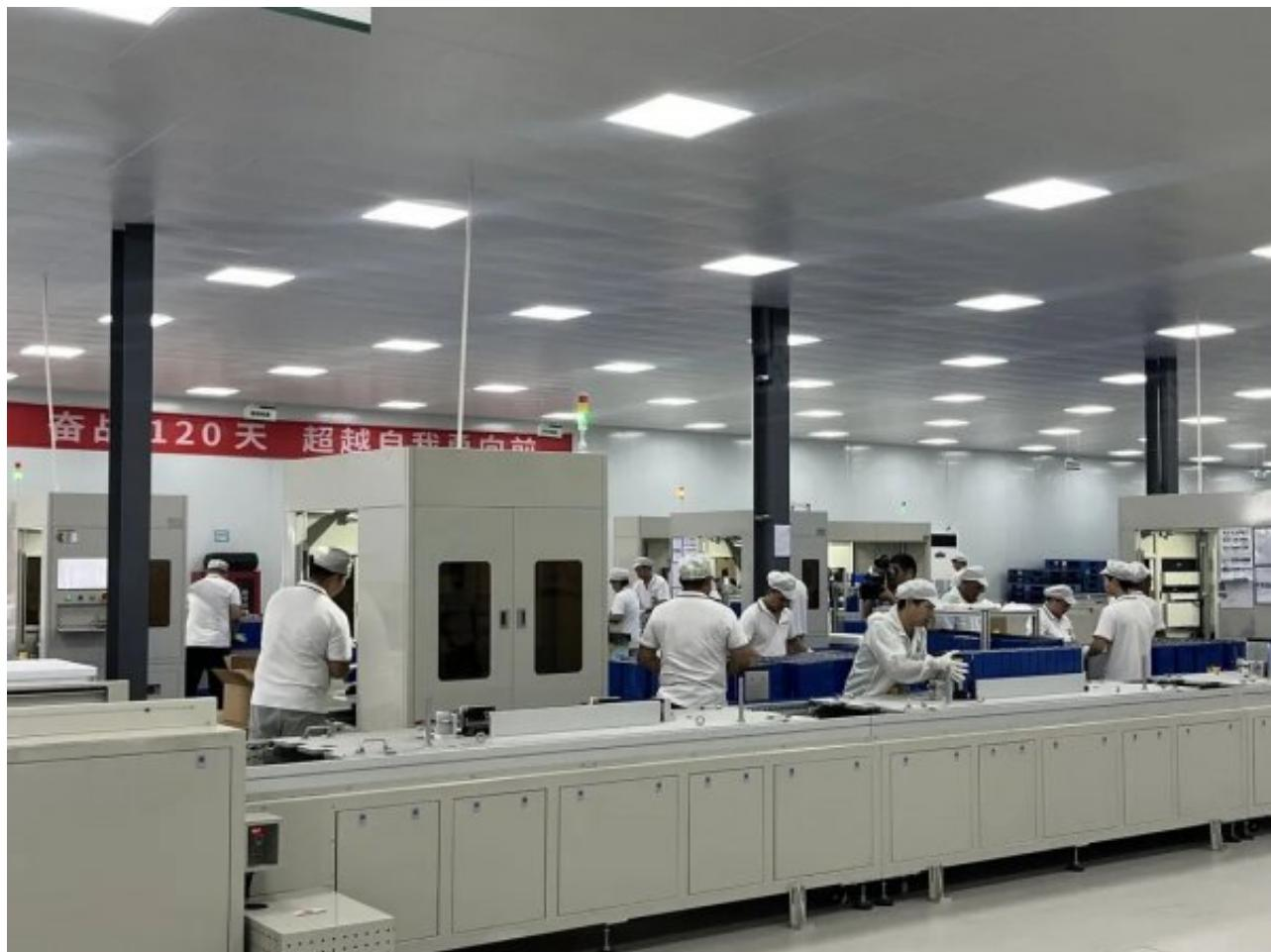
为推动项目早日投产见效，新建经开区主动靠前服务，协调原京冶科技厂房改造成南昌赣锋锂电PACK生产过渡厂房。该厂房总用地面积约1.5万平方米，目前已建成一条产能32PPM的模组、PACK生产及储能集成制造系统，专注磷酸铁锂电池模组、PACK及储能系统集成生产。项目已承接2GWh订单，排产计划至11月底，日均可完成15MWPACK组装，日出货量超20MWh；订单全部完成后，预计将为新建区新增工业产值6~7亿元。“政府部门精准对接我们的生产需求，逐一破解建设与投产衔接难题，让我们实现‘边建设、边生产’。”南昌赣锋锂电科技有限公司生产经理黎修维表示。
