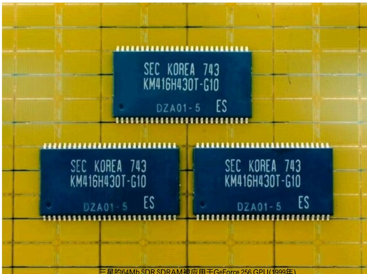
三星的64Mb SDR SDRAM被应用于GeForce 256 GPU(1999年)
