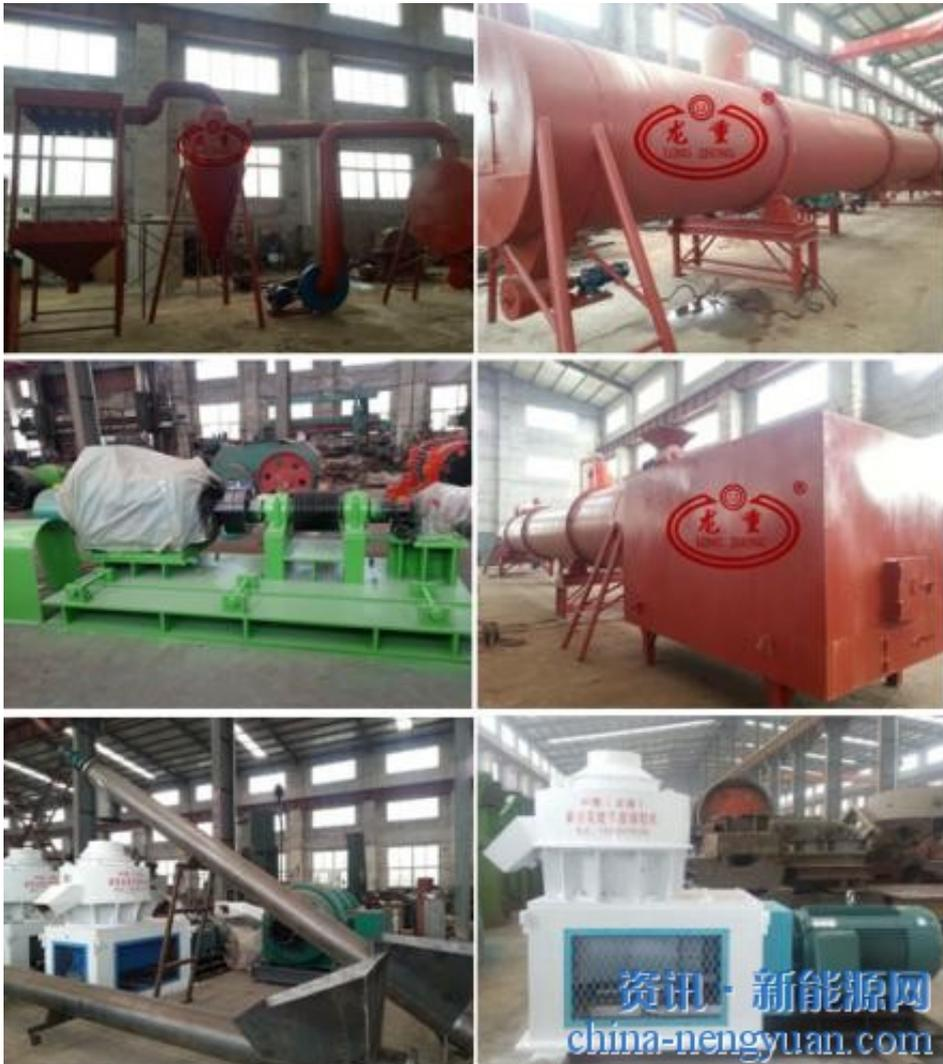
我公司致力于颗粒机及配套设备的创新与研发，于日前取得突破性进展---全套除尘与烘干系统。该项目是由我司自主研发，经过多项试验以及不懈的完善终于研制成功并完成安装调试，该系统包括两大部分—除尘系统和烘干系统。
