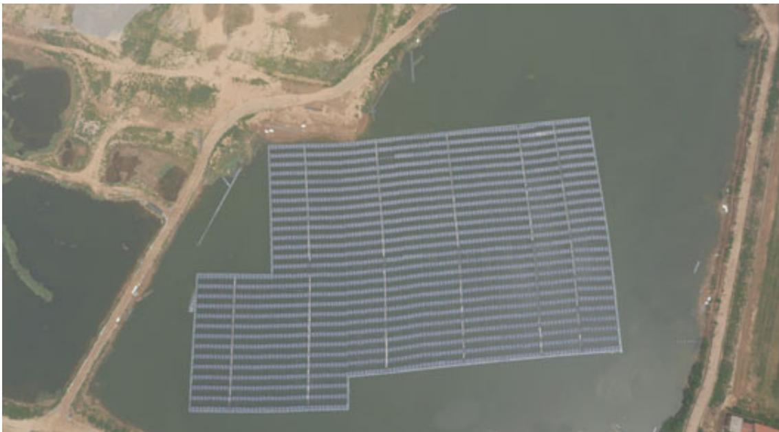
据项目负责人介绍，该项目在工程上不论是安装太阳能电池板的角度，还是每排浮岛电池板的间距，都充分考虑了渔业养殖的要求，做到不影响水下虾、鱼类的生长。同时与陆地上的光伏电站相比，水上光伏电站的发电量可高出10%，而且对水生态环境的破坏也较小。尤其值得指出的是，漂浮于水面上的光伏电站可阻挡阳光，防止湖内的水藻大规模爆发，并且为淡水生物提供一个最佳的孵化环境。在炎热的夏季，水面上安装了光伏组件之后可以有效的降低水温，不但可以有效的阻止疾病爆发，还可以调节鱼类的代谢能力使其优质快速生长，真正实现了渔业增产和节能减排两不误。
