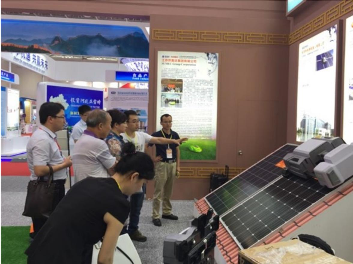
针对以上市场缺口，采用无水设计的科沃斯工业清洁机器人锐宝面世。当放置在太阳能电池板上时，锐宝通过内置真空泵安全地吸附在斜坡面板上，以独特的伸缩模式行走，无需安装特点移动轨道，行动自由灵活，边刷配合双滚刷高速清扫，无刷电机强劲吸尘，行走时完成“扫、吸、吹”同步完成。清扫覆盖率为100%，清洁效率为35m<sup>2</sup>/H，能清洁太阳能电池板表面99%的灰尘。而锐宝独特的无水清洁方式，也极大地节约了水资源与成本。尤其重要的是，锐宝自主规划清洁的模式，把人从繁杂、危险、恶劣的工作环境中解救了出来，让机器人成为这些特殊岗位上的最佳雇员，而这也是科沃斯商用机器人未来要坚持的使命。
