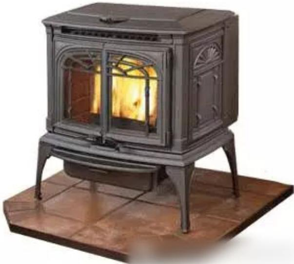
颗粒炉是独立式供热系统。它们可以安装在任何房间，并且最好作为二级焦点使用，这意味着还有另一个焦点，如娱乐间、书房或落地窗等。它们可以安装在平壁或角落。设备的排气装置通常可以直接安装在外墙，直上几英尺，然后转出去外墙（如在地下室），或直线上升，通过天花板和屋顶，请确保其安全适宜。大多数颗粒炉需要在地板上放置非易燃的垫板。颗粒炉是现有木柴炉很好的替代品，占更少的室内空间。
