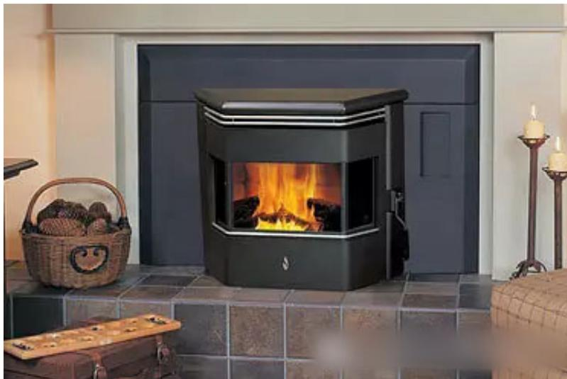
颗粒壁炉通常安装在燃木壁炉的位置。你需要和当地的设备经销商一起测量壁炉尺寸（高度、宽度和深度），以了解哪种是最适合你的壁炉。安装前需要清理你的壁炉和烟囱。通常情况下，嵌入的一部分会在燃烧室后面和还有一部分在炉膛。颗粒壁炉一般通过现有的烟道排放。
