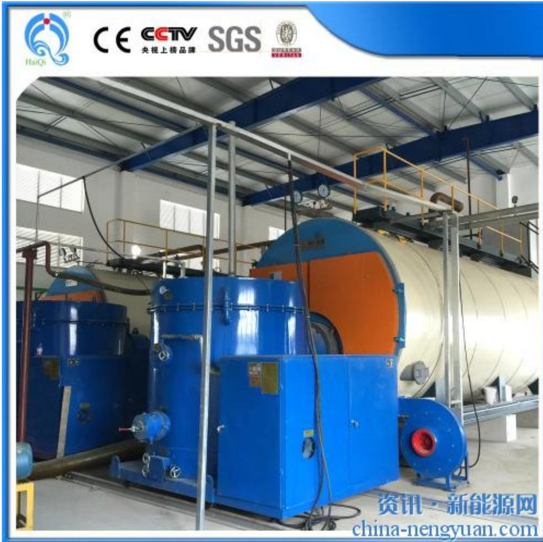
将运行中的中小型燃煤锅炉改造成使用生物质燃烧机在经济和技术上可行；可有效降低SO<sub>2</sub>的排放，烟气经除尘可达到国家排放标准。具有明显的环境效益；可促进可再生能源的发展，实现农业和林业有机废弃物的综合利用具有一定的社会和经济效益。
