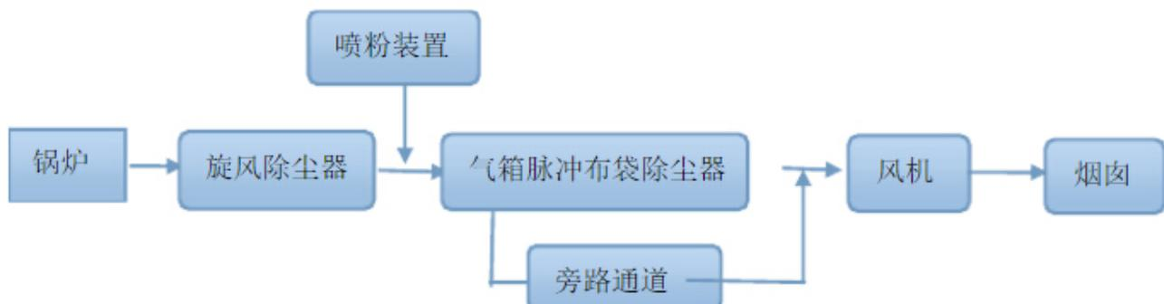
(1) 针对生物质燃烧尾气粉尘中含有碳黑等粘滞性成分，易造成黏袋，设备喷粉系统，安放在旋风分离器与布袋除尘器之间的烟道上。
