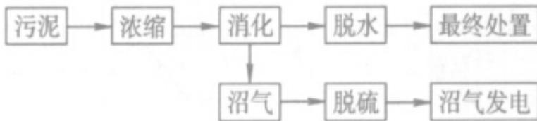
图 1 污泥厌氧消化产沼气工艺流程
