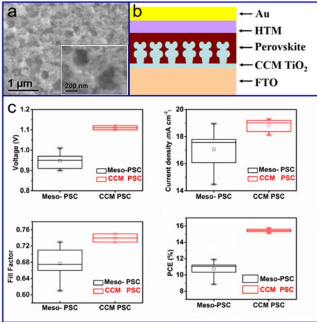
图 1. (a) CCM TiO<sub>2</sub> 薄膜 SEM 表面形貌图；(b) 基于 CCM TiO<sub>2</sub> 薄膜钙钛矿太阳电池结构示意图；(c) 基于 CCM TiO<sub>2</sub> 薄膜钙钛矿太阳电池和常规介孔钙钛矿太阳电池 (Meso-PSC) 光伏参数分布图。
