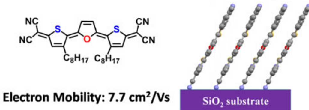
图1. 呋喃-噻吩吡啶式分子的结构式及其在器件中的堆积结构。
