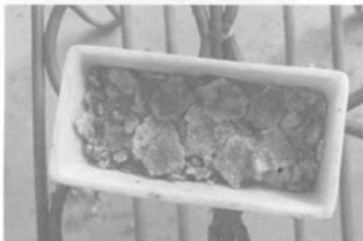
图 5 加热至 650℃时的试验样品形态
