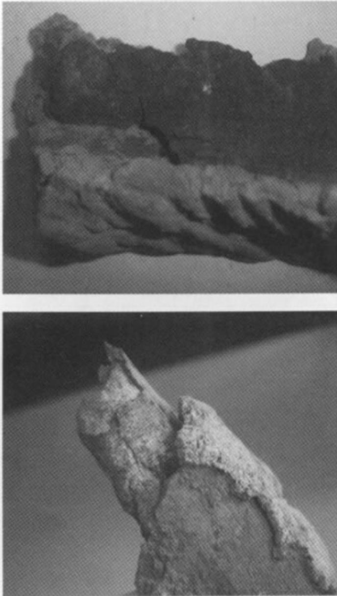
图 2 三级过热器管排腐蚀垢样照片
