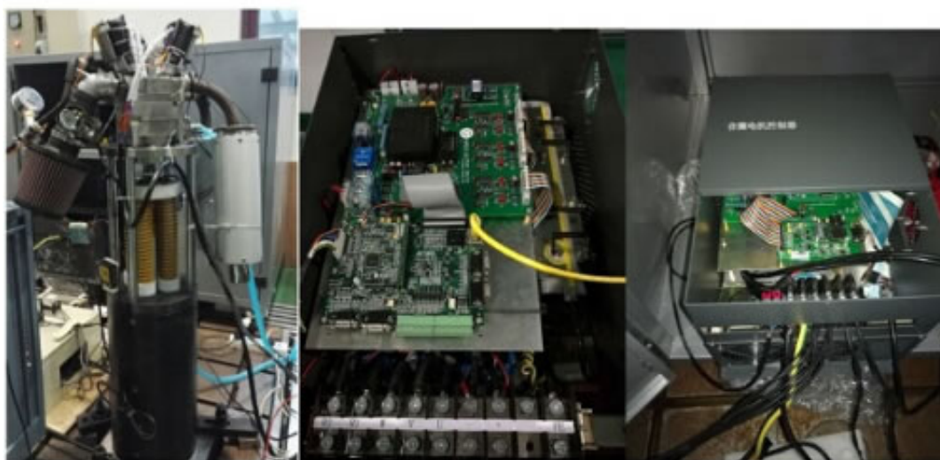
圆筒音圈电机测试平台 平板直线电机以及音圈直线电机驱动控制器
