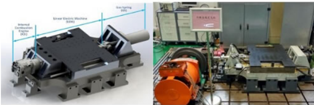
平板型直线电机本体三维设计图 平板型直线电机测试平台
