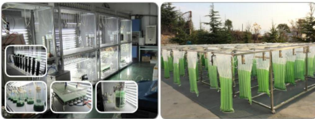
图2. 蓝细菌乙醇光合工程藻株的实验室培养和户外规模化培养
