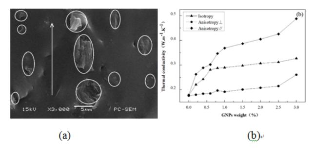
(a)石墨烯在强磁场下取向形成各向异性结构,图中箭头表示磁场方向;(b)石墨烯/PDMS热导率与石墨烯质量分数和结构的关系。Isotropic代表各向同性试样热导率,Anistropic 代表平行于磁场方向的热导率,Anisotropic 表示垂直于磁场方向的热导率。
