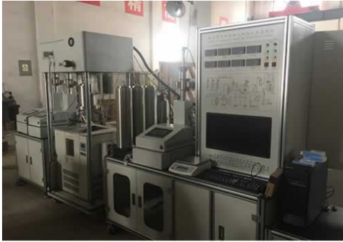
图1. 含天然气水合物土的三轴测试系统
