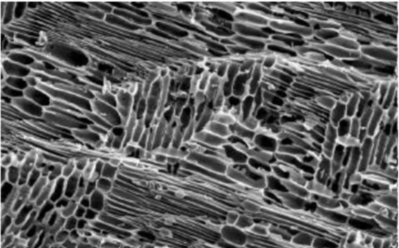
图 2 生物质炭的微观结构<sup>[13]</sup>
