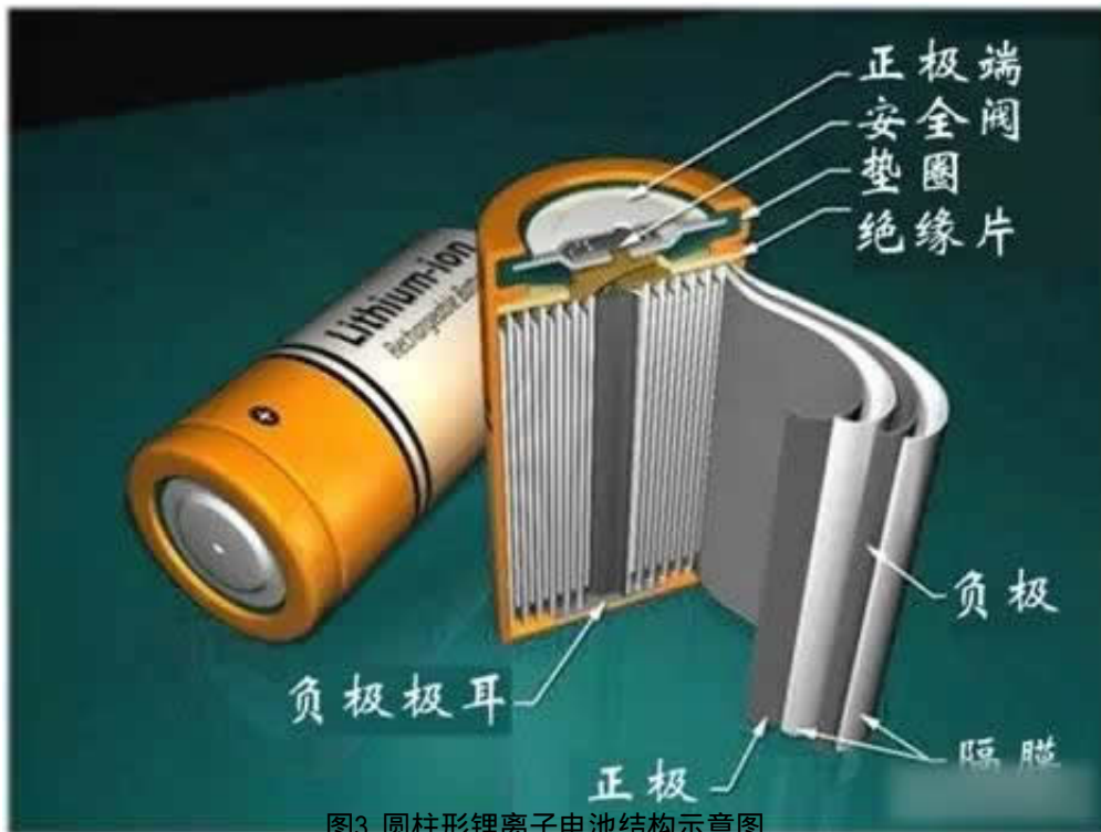
图3. 圆柱形锂离子电池结构示意图。
