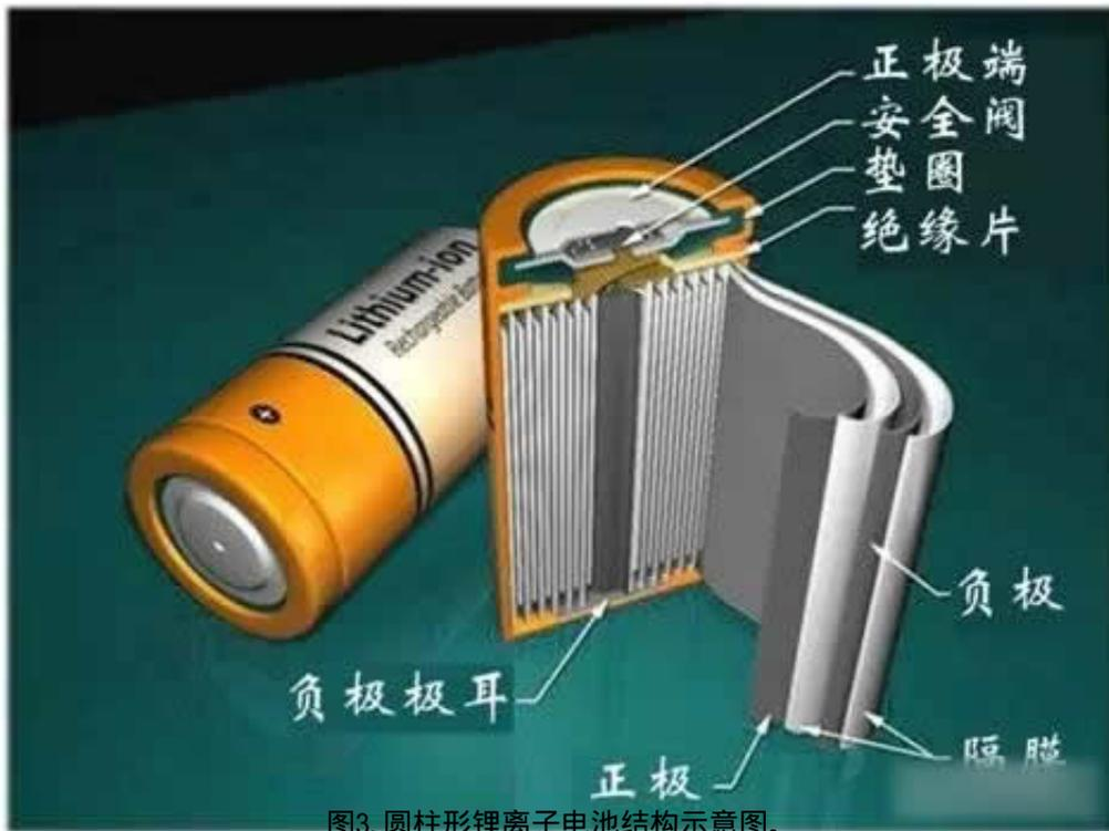
图3. 圆柱形锂离子电池结构示意图。
