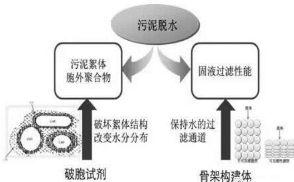
图2污泥破胞复合调理技术原理
