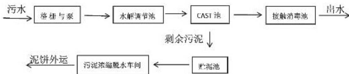
图1CAST工艺方案流程图
