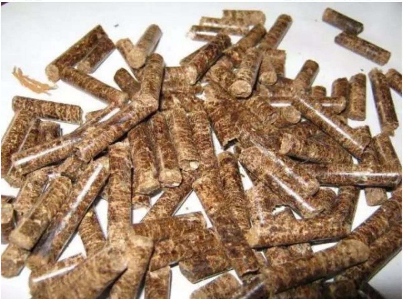
生物质颗粒固化成型通常被分为干燥粉碎阶段、预压缩阶段和成型压缩阶段3个阶段，其中成型压缩阶段是最重要
