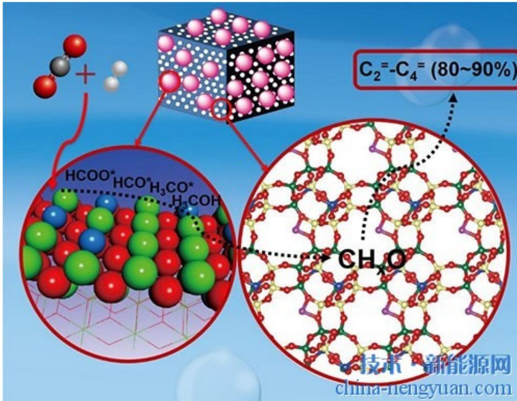
中国科学院大连化学物理研究所李灿团队在CO<sub>2</sub>催化加氢制备低碳烯烃方面取得新进展：实现串联式催化剂体系上直接将CO<sub>2</sub>高选择性的转化为低碳烯烃。
