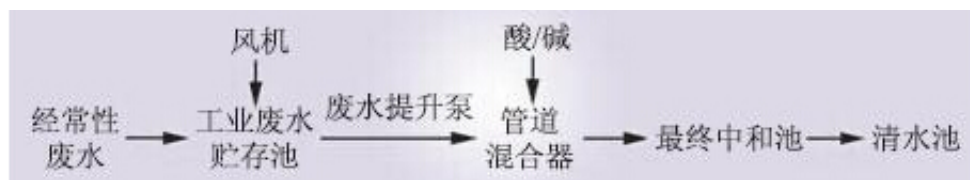
图1经常性生活污水处理工艺流程示意
