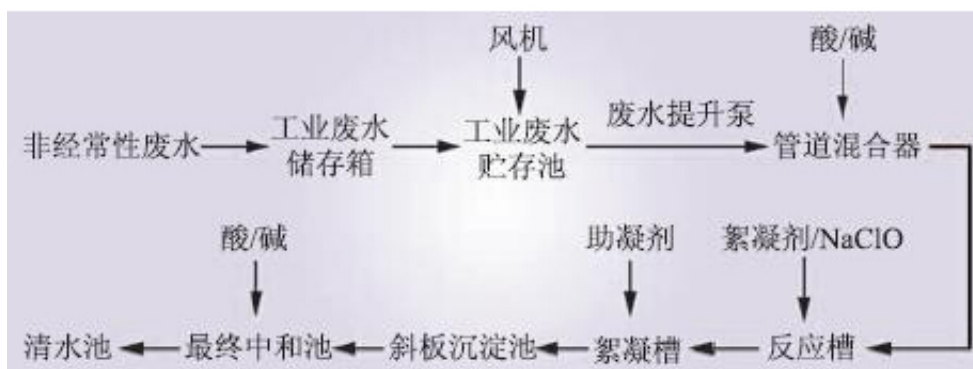
图2非经常性废水处理工艺流程示意
