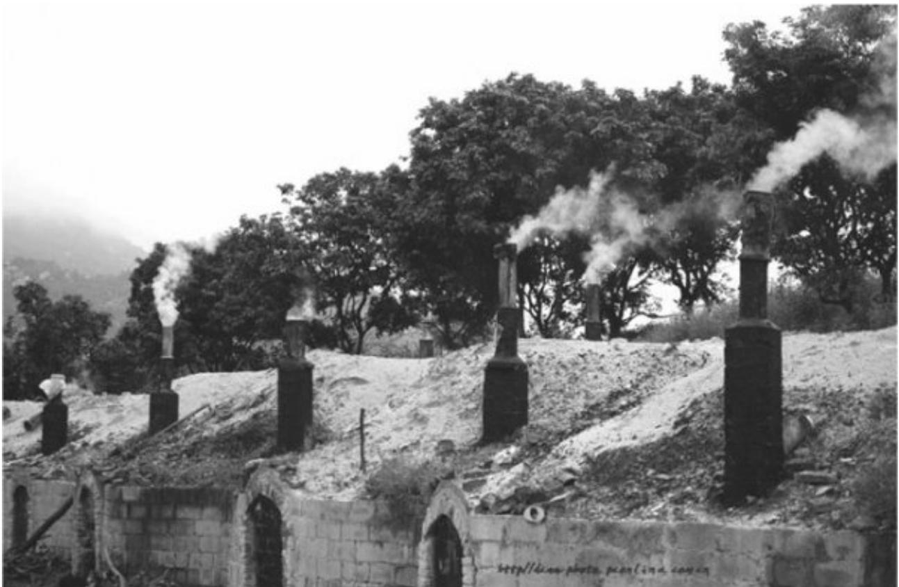
图 1 传统窑式炭化炉
