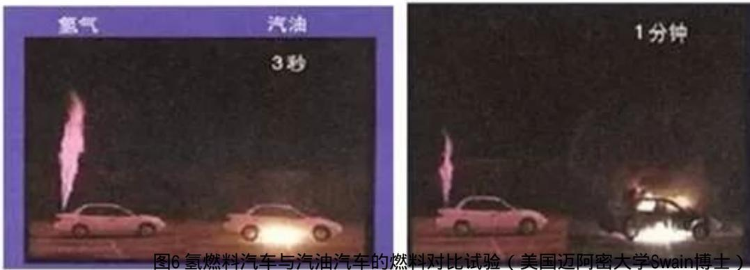
图6 氢燃料汽车与汽油汽车的燃料对比试验（美国迈阿密大学Swain博士）
