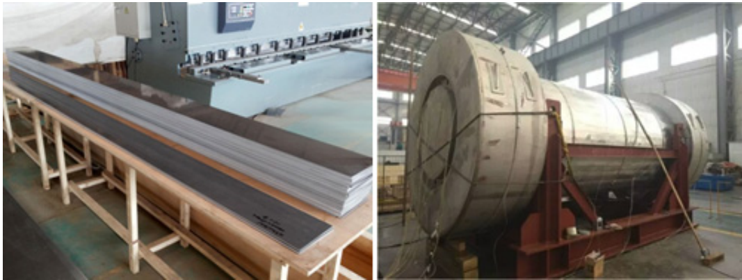
龙舟-CNSC乏燃料运输容器用碳化硼铝中子吸收板及容器原型样机
