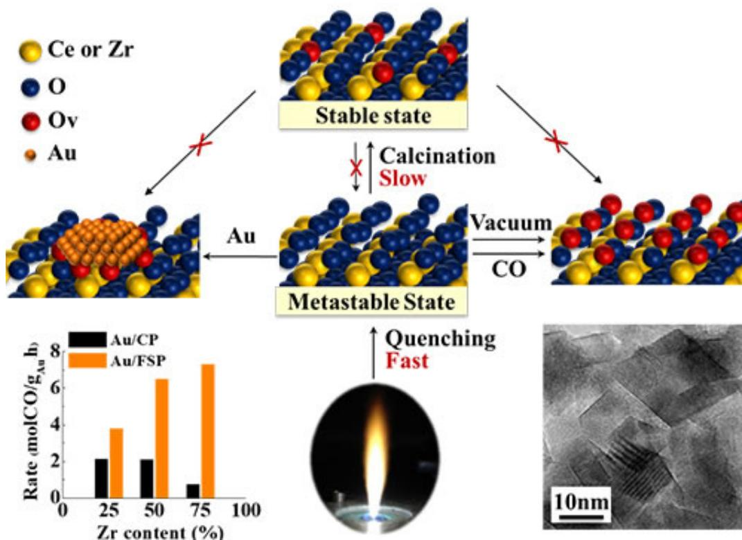
近日，中国科学院大连化学物理研究所碳资源小分子与氢能利用创新特区研究组副研究员孙剑、俞佳枫团队利用火焰喷射法（Flame Spray Pyrolysis, FSP）的高温淬火过程，将金属氧化物中的晶格氧锁定在亚稳态，从而大幅增强了晶格氧的活性，使CO氧化反应速率比传统催化剂的反应提高了10倍。
