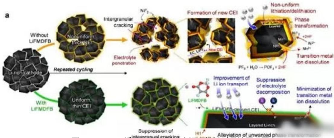
图3：LiFMDFB诱导的保护层对富锂正极材料保护原理图
