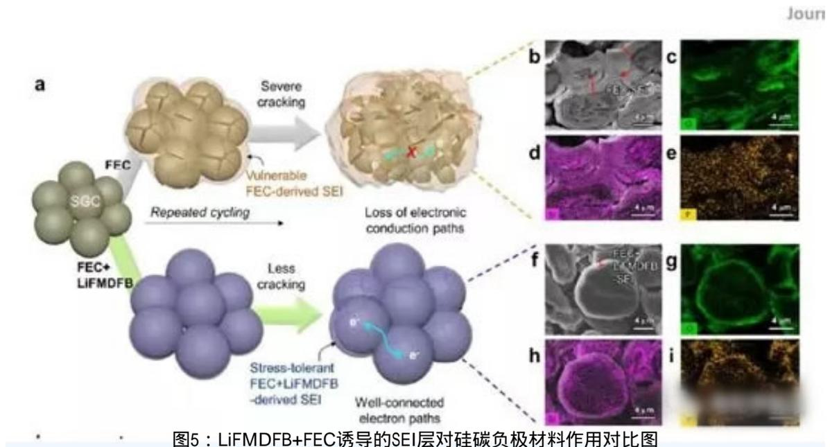
图5：LiFMDFB+FEC诱导的SEI层对硅碳负极材料作用对比图
