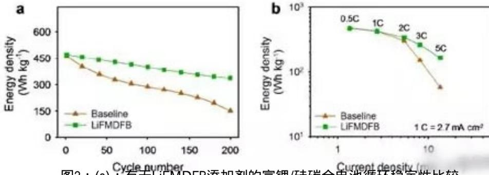
图2：(a)：有无LiFMDFB添加剂的富锂/硅碳全电池循环稳定性比较
