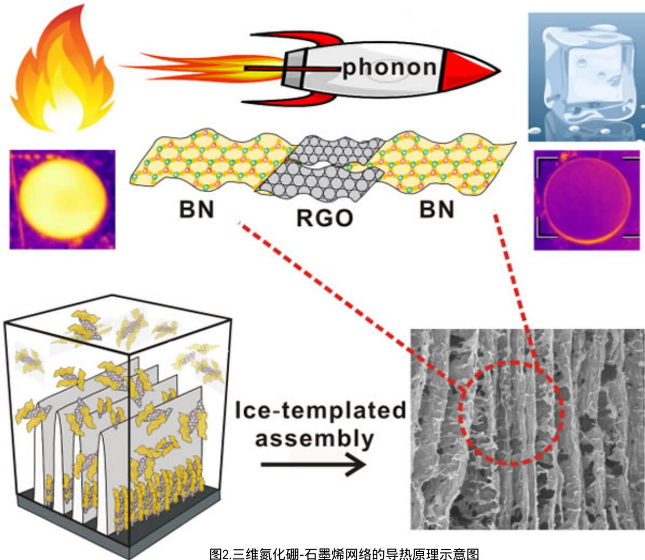
图2.三维氮化硼-石墨烯网络的导热原理示意图
