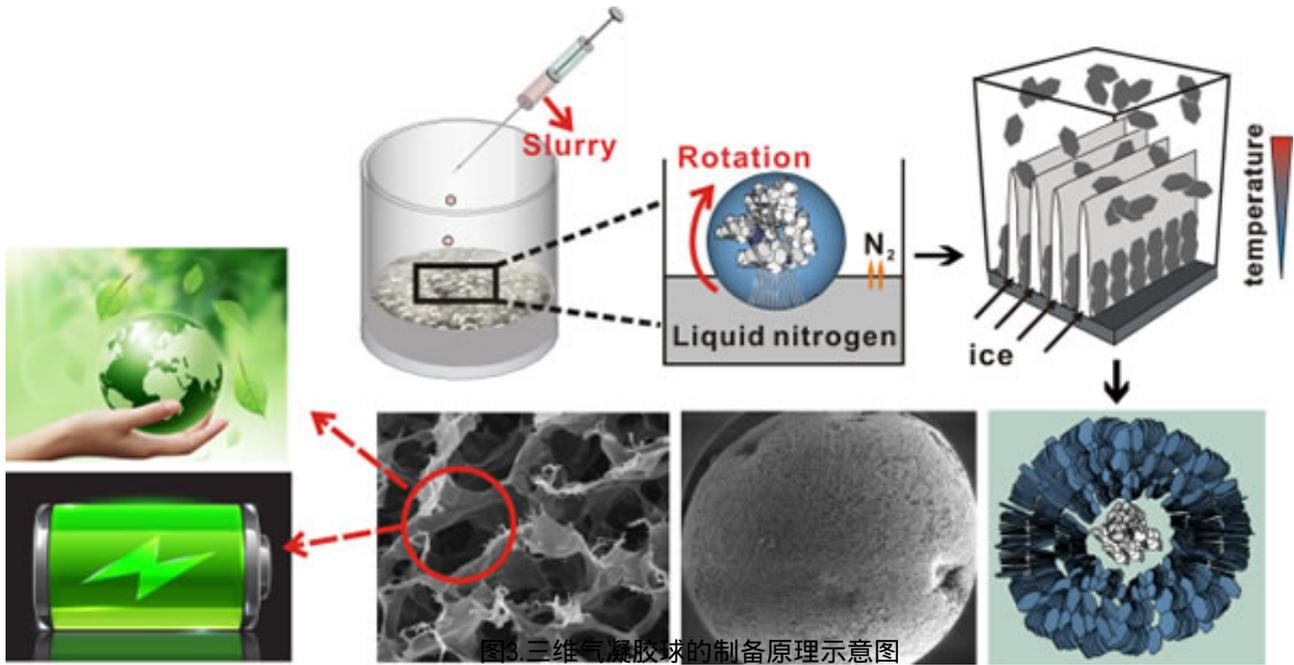
图3. 三维气凝胶球的制备原理示意图
