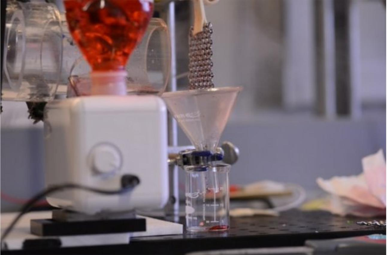
由Maher Damak博士和副教授Kripa Varanasi领导的团队开发的该系统是对现有雾网技术的一种变体，该技术包括使用垂直悬挂的细网捕捉通过它们的潮湿空气中的水滴。那些收集的液滴随后滴下网眼，并收集在底部的槽中。这些网的问题之一是空气自然趋向于在其路径中的物体周围流动- 例如组成网状物的线 - 使液滴通过这些线之间的间隙。因此，大多数雾网只能捕获通过它们的大约1%到3%的水滴。
