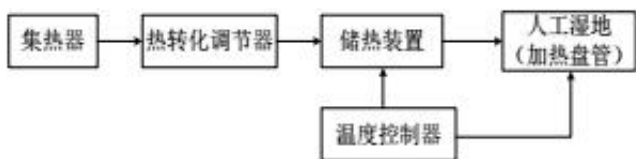
图1 太阳能加热人工湿地工艺流程图
