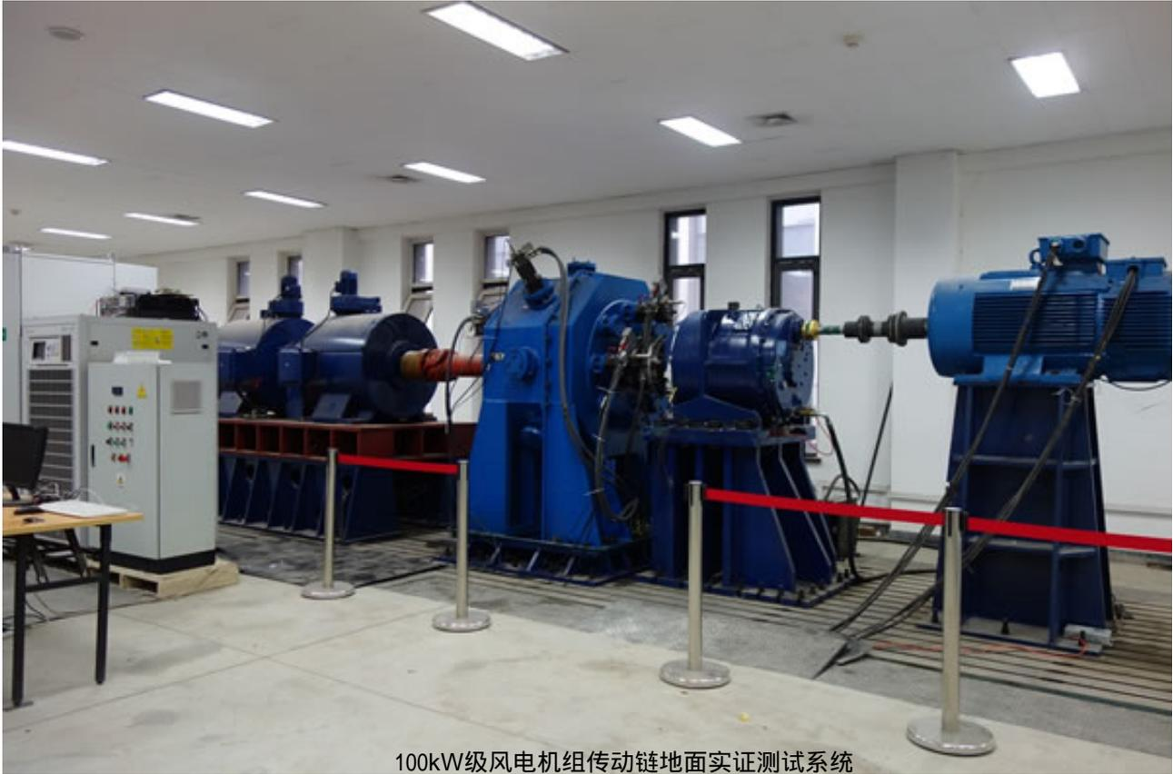
100kW级风电机组传动链地面实证测试系统
