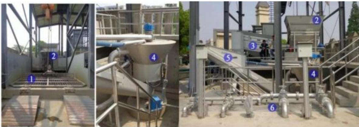
①大型杂物筛分 ②平衡喂料 ③粗大物质分离和洗涤(洗涤转鼓) ④沉砂分离和洗涤工艺(洗砂装置) ⑤螺旋输送机 ⑥冲洗水水泵
