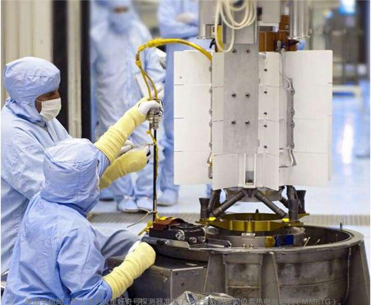
美国宇航局工作人员为火星好奇号探测器准备了多条放射性同位素热发电机（MMRTG）。
