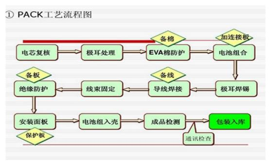
锂电池的PACK通过二种方式实现,一是通过激光焊接或超声波焊接或脉冲焊接,这是常用的焊接方法,优点是可靠性较好,但不易更换。二是通过弹性金属片接触,优点是不需焊接,电池更换容易,缺点是可能导致接触不良。
