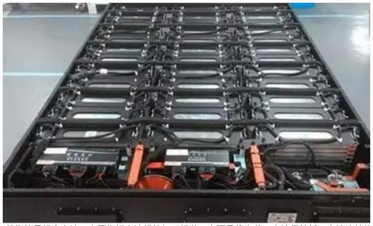
电池PACK一般指的是组合电池,主要指锂电池组的加工组装,主要是将电芯,电池保护板,电池连接片,标签纸等通过电池PACK工艺组合加工成客户需要的产品。电池PACK在现在主要集中在锂电池包PACK厂,都捅有自己的PACK结构设计,PACK电子设计和PACK生产车间,能根据客户的需求进行自主的开发设计,通过电池方案,电池规格书,电池样品达到客户的PACK锂电池定制需求确认后,再让PACK车间的PACK生产线进行生产加工,品质检验合格后出货。
