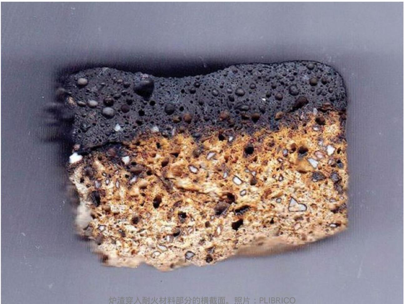
炉渣穿入耐火材料部分的横截面。照片：PLIBRICO
