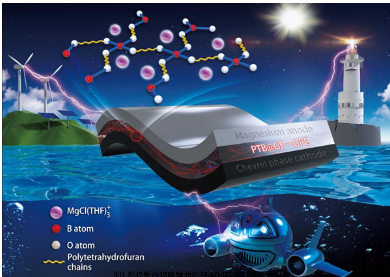
图1 凝胶聚合物电解质的结构和应用领域示意图
