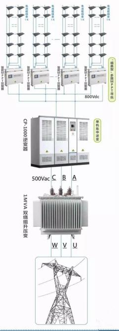
光伏逆变器按照适用场所分为集中式逆变器、集散式逆变器、组串式逆变器以及微型逆变器。集中式和组串式逆变器我相信大家都不很清楚其中的区别，今天我们主要讲一讲集散式光伏逆变器，集散式光伏发电解决方案是指：分散MPPT寻优，集中并网发电形式，通过前置多个MPPT控制优化器，实现多路MPPT寻优功能，汇流后采用集中式逆变器逆变的新型、高效光伏发电解决方案。
