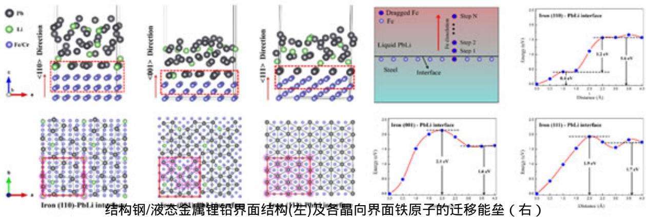
结构钢/液态金属锂铅界面结构(左)及各晶向界面铁原子的迁移能垒(右)
