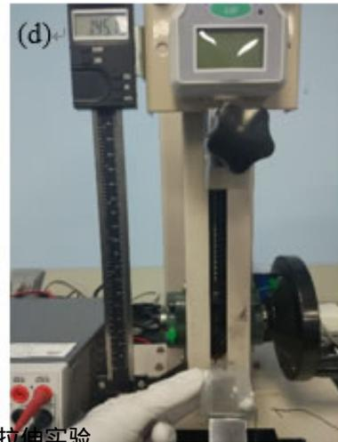
超高可拉伸传感器的拉伸实验
