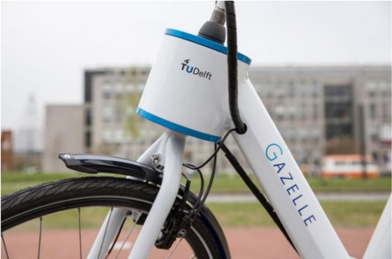
如果确定自行车即将翻倒，安装在转向管内的电动马达将轻轻转动车把，以防止发生这种情况。尽管该技术仍需要进一步发展，但一些测试车手已经报告说这确实有助于他们使自行车保持直立。
