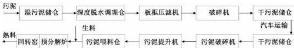
图1 上海万安华新污泥处置工艺流程<sup>[11]</sup>
