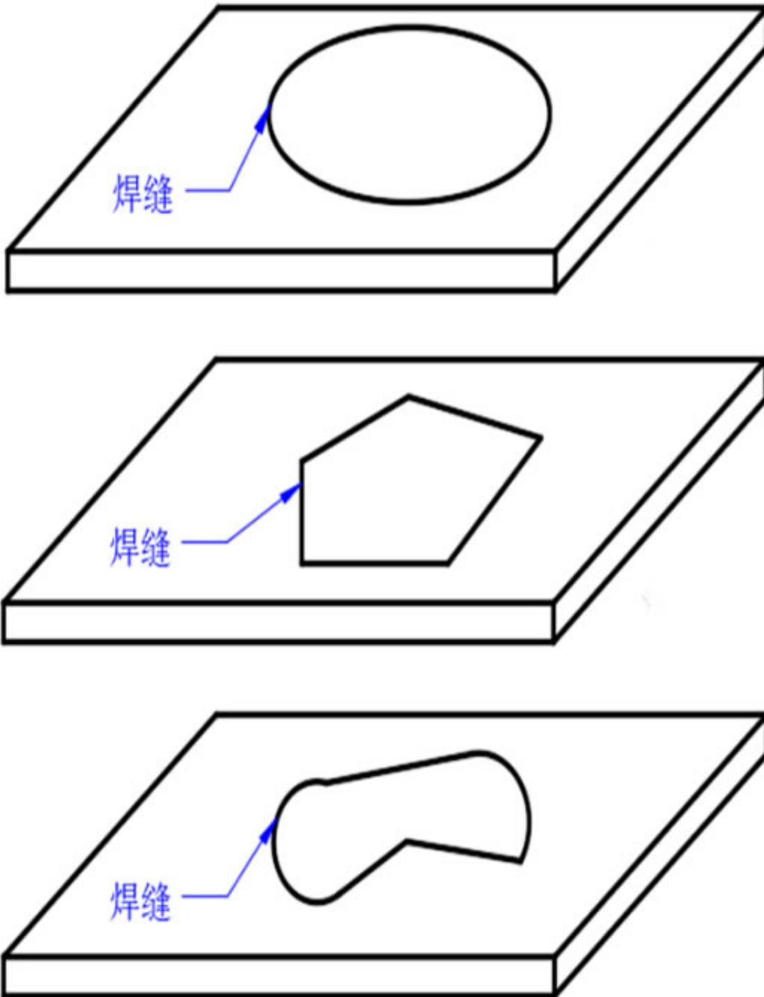
图4 平面封闭图形状焊缝
