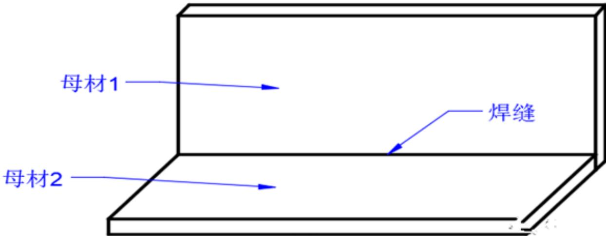
图3直线状焊缝
