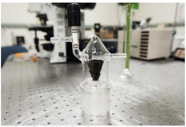
结果发现,这种设置允许更多的阳光照射聚吡咯,因为未被一张纸吸收的光被反射到另一张纸上。另外,增加了水蒸气消散的表面积。
