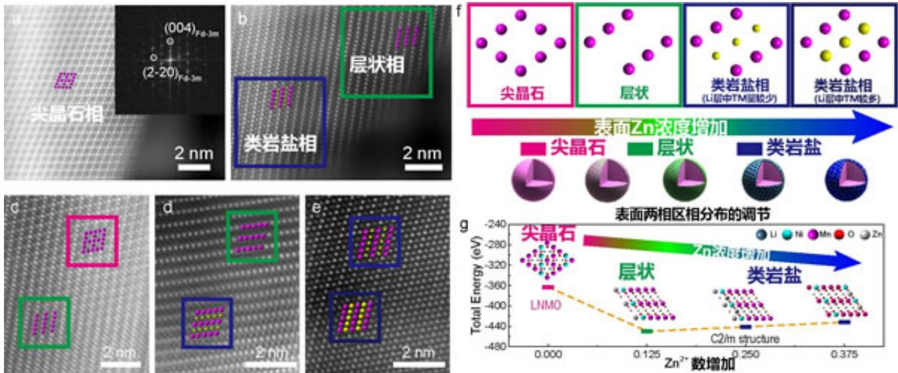
Zn<sup>2+</sup>促使尖晶石结构表面产生相变：精确控制固相反应，获得层状和类岩盐共存的表面两相区，基于相结构和构成的优化提升电极材料的稳定性
